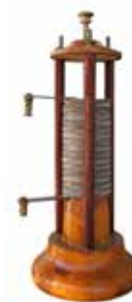
La pila di Volta è il primo rudimentale generatore di corrente continua.
